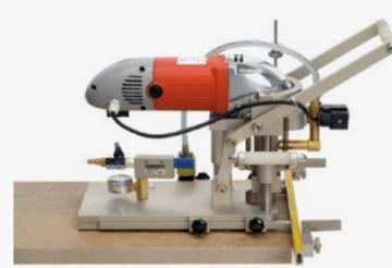
Herramienta para fachadas ventiladas HFV de Maincer DKT2 y DKT3
