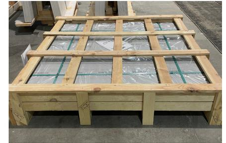
→ Verpackung in einer Kiste für großformatige Bodenbeläge.
