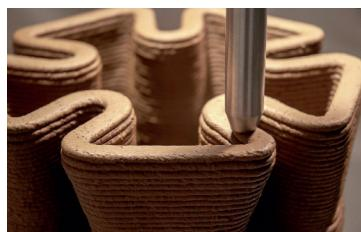
El proyecto Pylos investiga actualmente una forma de imprimir en 3D y a gran escala, como un método de construcción que utiliza materiales locales, naturales, biodegradables y reciclables.
