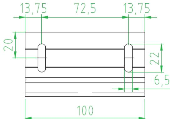
**Figura A2.3b:** Grapa de arranque/coronación. Vista frontal.
