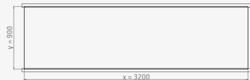
H4. Max. Ontwerp windbelasting: 1.0 kN/m²
