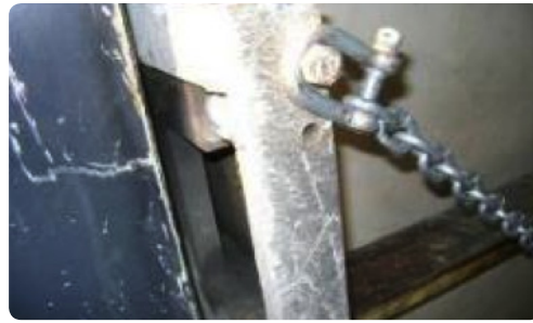
Fijación de la cadena al portahorquillas.
