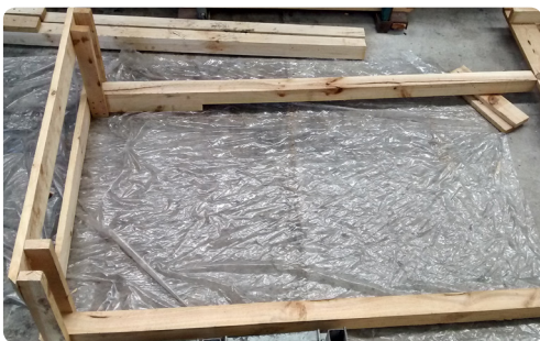
Foto 4: creación de la base. Los listones están cortados a inglete
