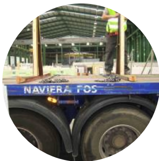
Colocación del caballete trasero (sobre los ejes)
