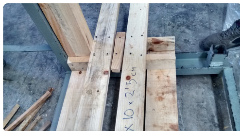
Foto 4: creación de la base. Los listones están cortados a inglete
