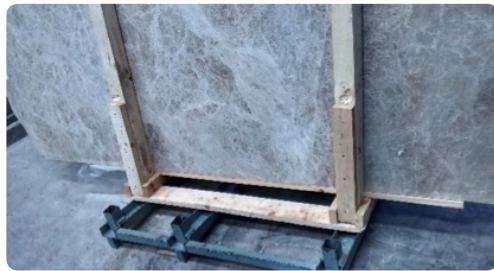
Foto 3: apoyo de las piezas sobre las marcas a 1,30m de distancia
