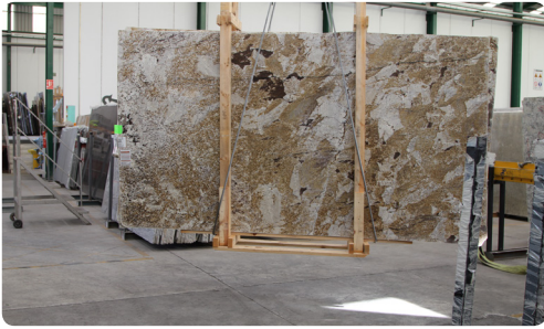
Eslingado de la carga y acercamiento al contenedor
