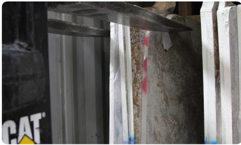
Las horquillas se introducen lentamente a media altura.
