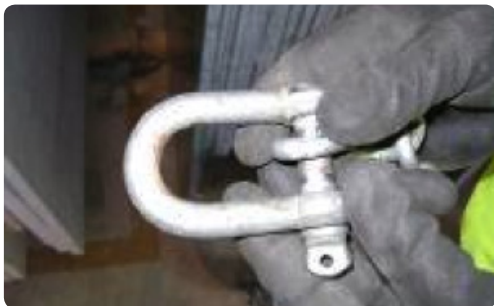
Detalle del grillete (mod.: M14 SWL0757).
