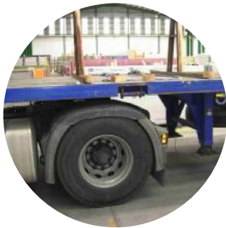
Colocación del caballete delantero (sobre el eje).
