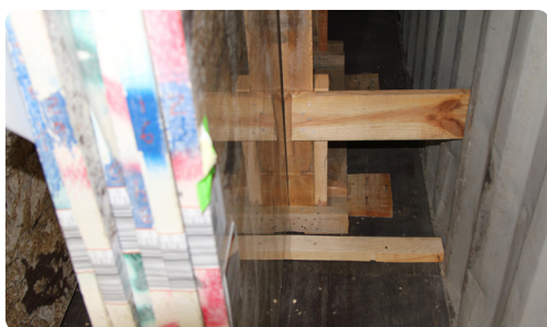
Detalle de la fijación lateral en la segunda fila de carga.
