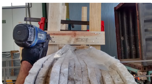
Detalle de la fijación del listón a la base.
