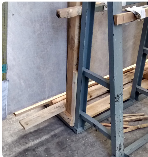
Foto 3: apoyo de las piezas sobre las marcas a 1,30m de distancia
