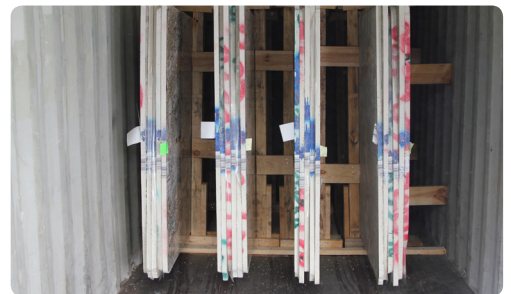
Primera fila de carga con tres bundles (finalizada):
