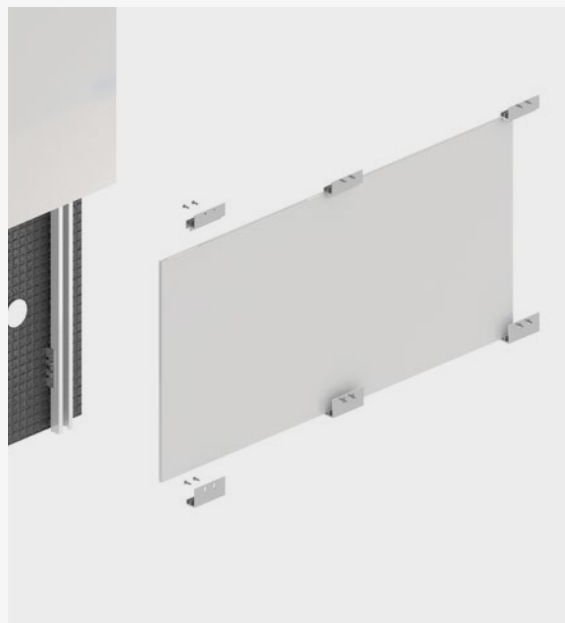
Detalhe dos grampos inferiores
